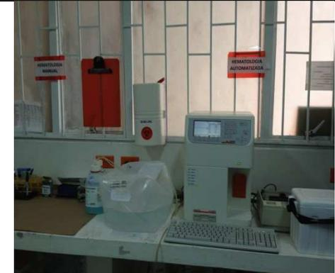
**Foto 4.** Equipo Hemacount, utilizado para conteo de cuadro hemático, es decir células de la línea roja y línea blanca.
